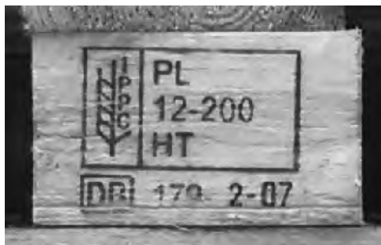
Fotografia 1.9. Oznaczenia na środkowym wsporniku palety
