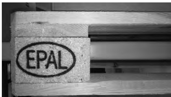
Fotografia 1.8. Wypalony w owalu znak EPAL na lewym wsporniku palety
