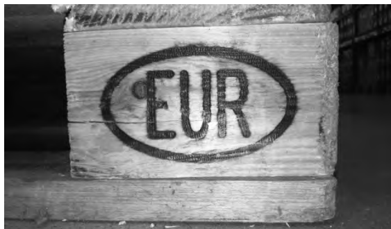
Fotografia 1.7. Wypalony w owalu znak EUR na prawym wsporniku palety
