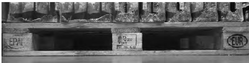
Fotografia 1.6. Oznaczenia na wspornikach palety
